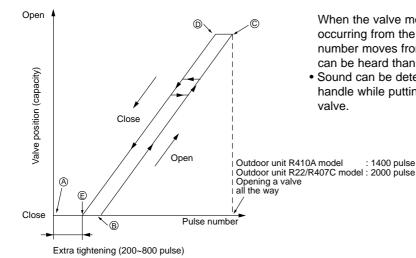
Closing a valve :  $1 \rightarrow 2 \rightarrow 3 \rightarrow 4 \rightarrow 1$ Opening a valve :  $4 \rightarrow 3 \rightarrow 2 \rightarrow 1 \rightarrow 4$
